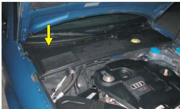
**PL** Filtr przeciwpłytkowy znajduje się za komorą silnika. Wyciągnąć maskownicę podszybia
